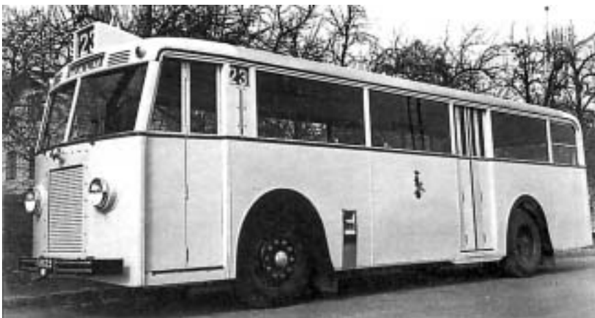
16 st. stadsbussar till Malmö Spårvägar. Katrineholmskaross och Mercedes Dieselmotor
