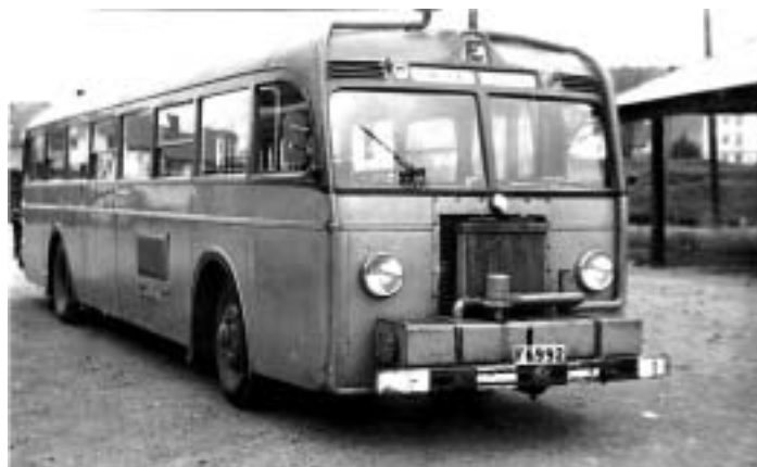
Motalabussen F 6992 försedd med gengas under krigsåren. Mer om Motala Verkstads tillverkade bussar kan Du läsa om på särskild sida.
