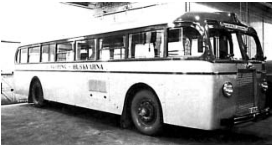
Huskvarnas Motala buss försedd med förlängt chassie. Vaggerydskaross och Mercedes Dieselmotor.
