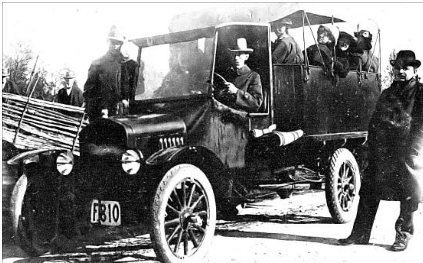
Kilians första buss F810 egenhändigt byggd på ett T-Fordchassi
