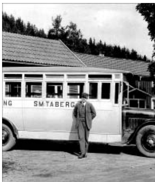
Kilians första buss F810 egenhändigt byggd på ett T-Fordchassi
